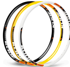
165-ARO 26" KODE SLIM 917 32 F PARA DISCO - 559X18C 539MM 28-54
