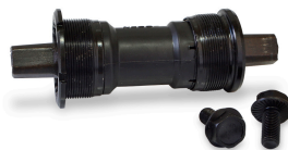
414-MOV. CENTRAL KODE BB906 QUAD. (C/PARAF) PTO 116MM(1.37X24) 68/70 / ESFERA
